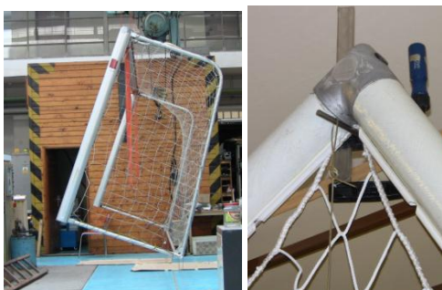
Obrázek 2 Experimentální určení polohy těžiště a momentu setrvačnosti branky
